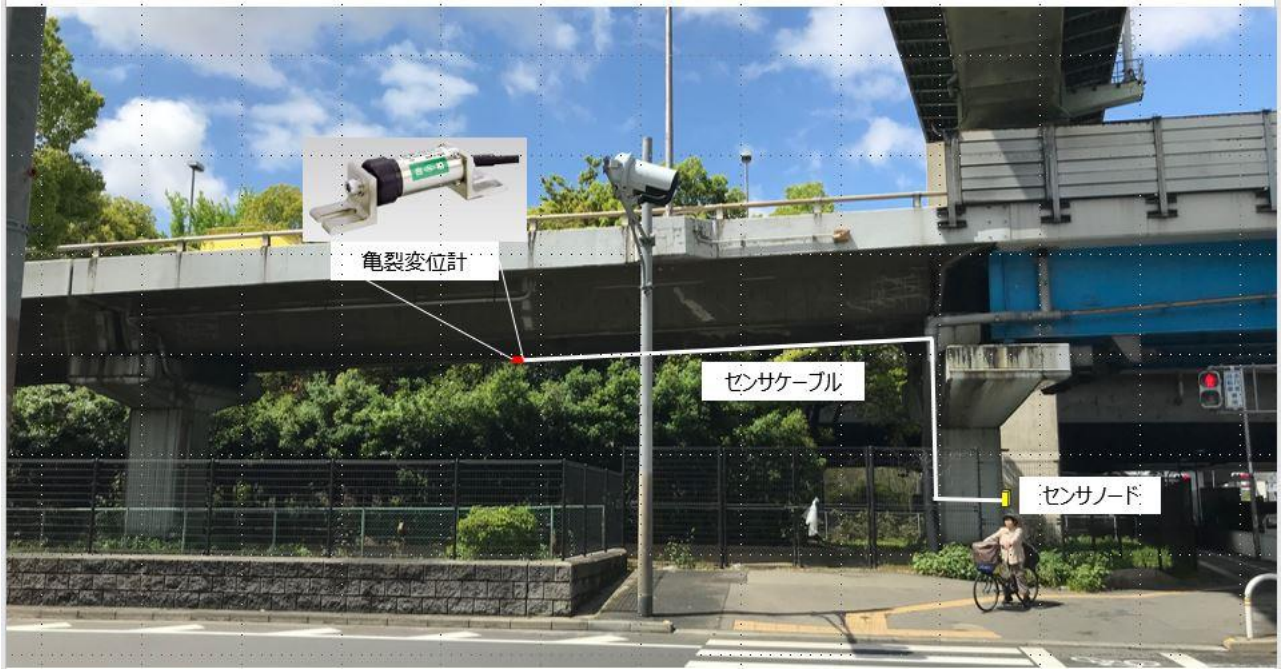
亀裂変位計とセンサノードの位置関係 (提供：大阪大学大学院 小泉圭吾助教)
