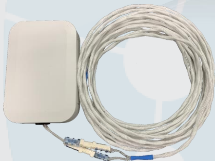
漏水検知帯接続イメージ
