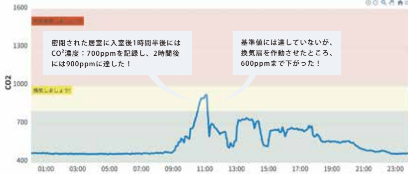
居室における二酸化炭素含有率測定の実証実験
